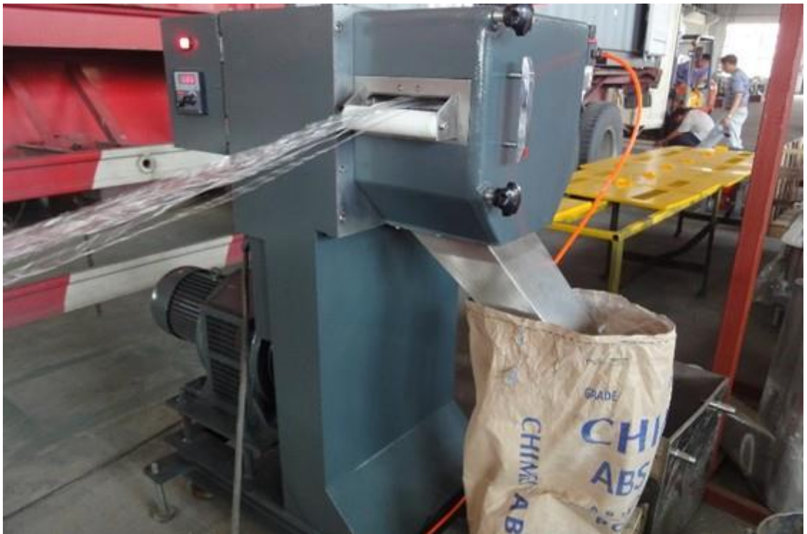
4-сурет-Түйіршіктеу құрылғысы (стрингтерге кесу))
