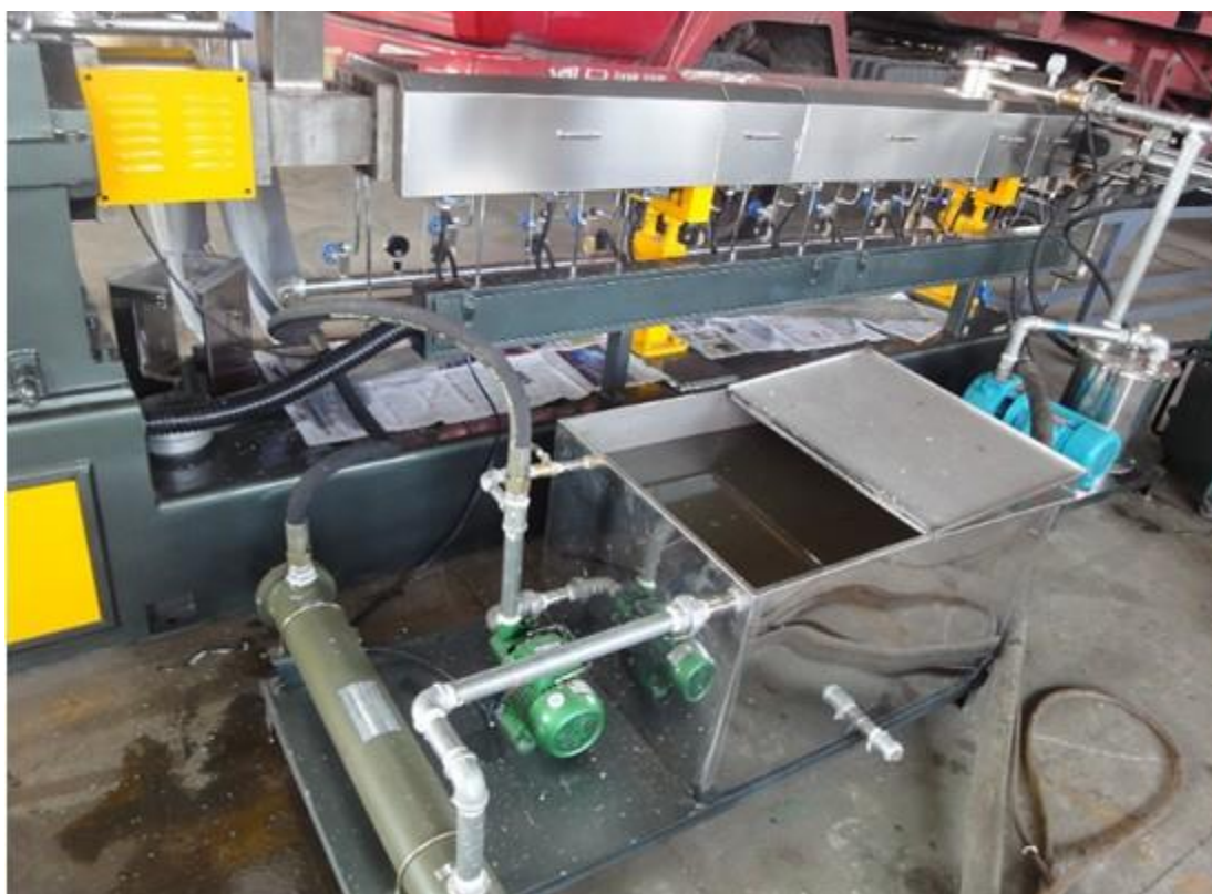
2-сурет-Су айналымы жүйесі (шнектер мен гильзаларды салқындату). Вакуумдық газсыздандыру жүйесі
